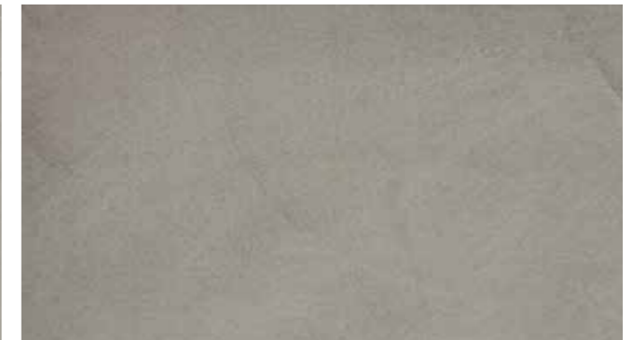
PANDOMO® Loft Bodenfläche behandelt mit: PANDOMO® SP-SL Steinöl, PANDOMO® SP-F Porenfüller und PANDOMO® SP-GS Seidenglanz-Siegel
